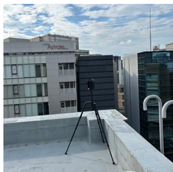
図2 3次元レーザースキャナによる計測状況
