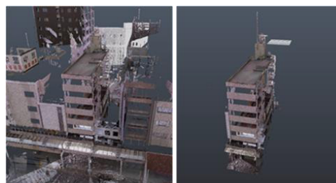
図9 点群データ整理前（左）と点群データ整理後（右）
