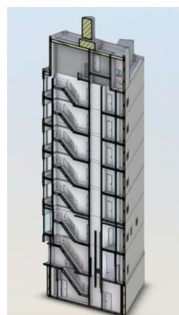
図4 作製した BIM データの例
