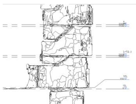
図3 タブレット端末上の測量アプリケーションによる3次元計測の例
