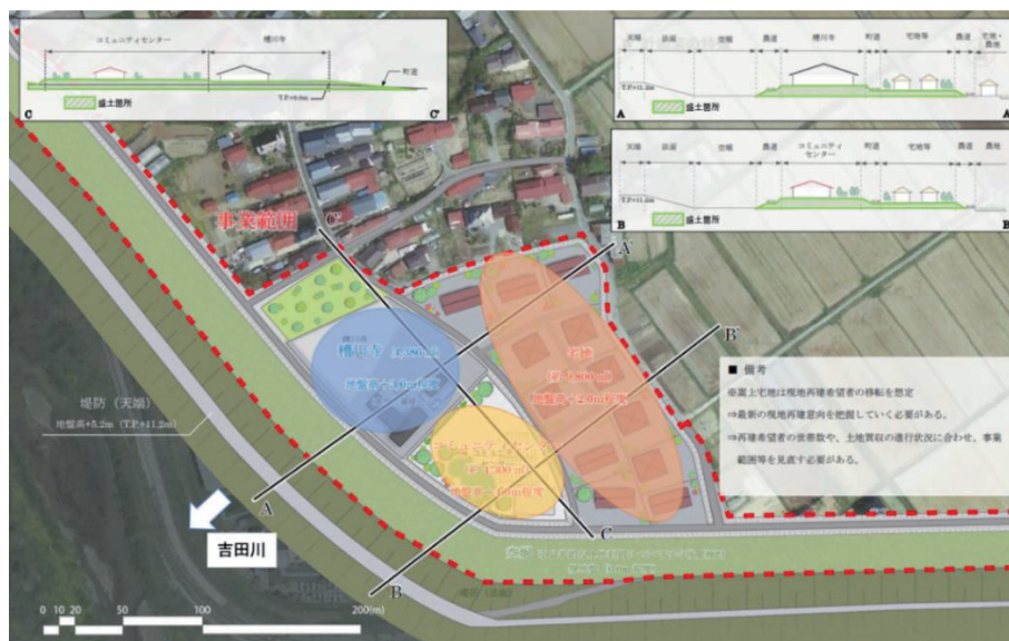
図 32 中粕川地区の河川改修と合わせた盛土等による安全度の確保
