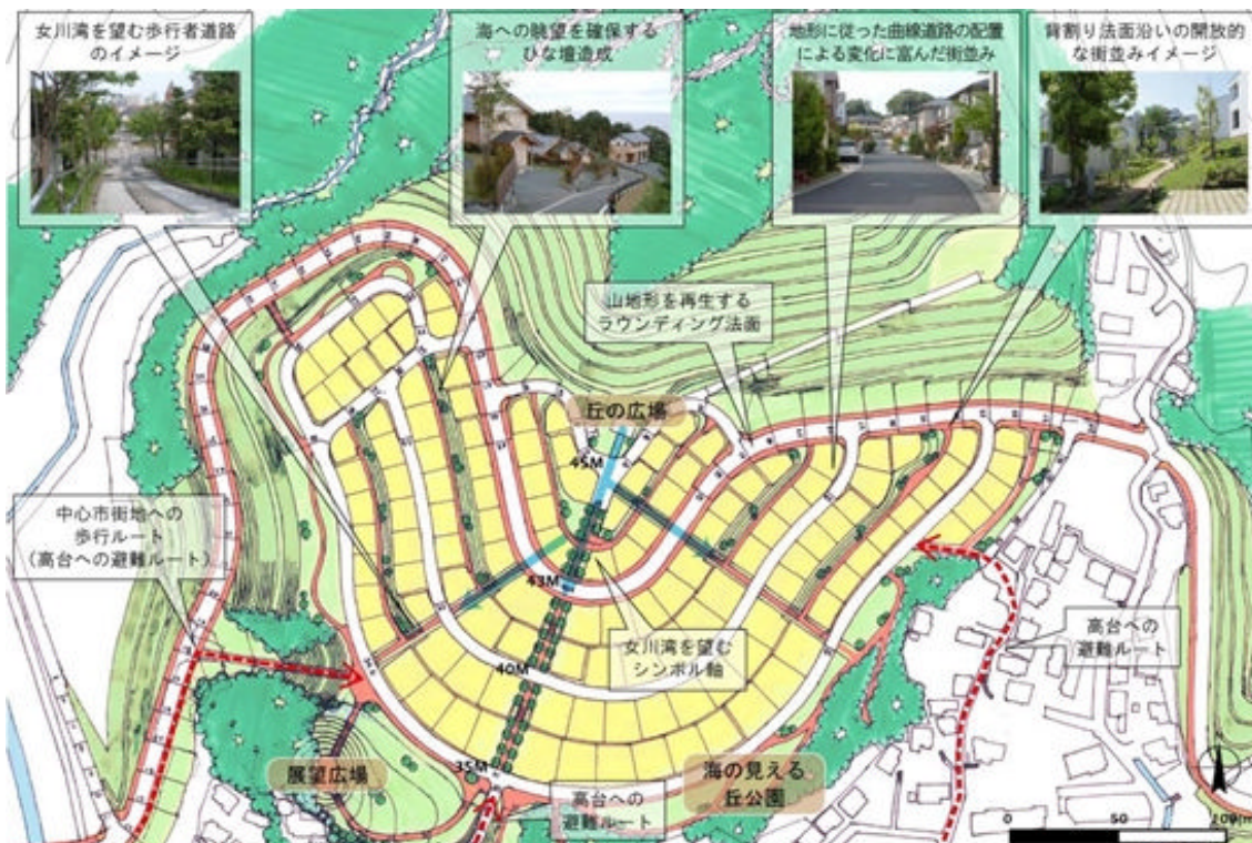
(図表-7) 宇野氏が斜面の地形を利用して切り土を減らすとともに管理が難しい擁壁をなくした事業計画案
